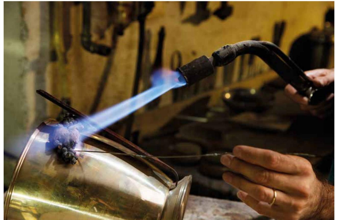
Saldatura di elementi realizzati in fusione su secchio champagne
